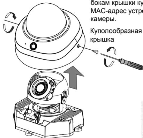
Прилагаемой отверткой Torx T10 выкрутите винты по бокам крышки купола и снимите ее. Затем перепишите MAC-адрес устройства, напечатанный с нижней стороны камеры.
